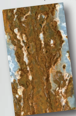
Cynkowanie ogniowe 20 µm po 6 tygodniach
