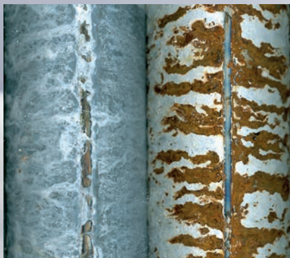
Magnelis® ZM120 spawanie bez odtworzenia powłoki ochronnej
